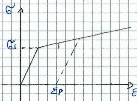
Se si è arrivati al comportamento plastico, si esce dallo stato di tensione per poi caricarlo nuovamente (prima a trazione e poi a compressione), si osserva che la curva di plastificazione viene raggiunta a una minore compressione (in modulo).
