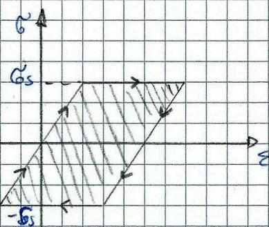
È il lavoro necessario a effettuare la trasformazione per unità di volume. Notiamo la dipendenza da  $\Gamma$ , del percorso di curva, da  $dL = \int dL dt$ .
