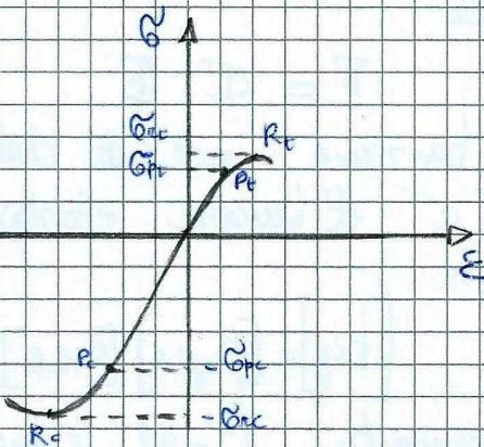
La fase elastica è non lineare e porta al raggiungimento della rottura senza fase plastica. La tensione di rottura  $G_{rt}$  è significativamente minore, in modulo, di quella  $G_y$  (rispettivamente di tensione e di compressione). Per questo il comportamento meccanico dei materiali fragili è dissimile.
